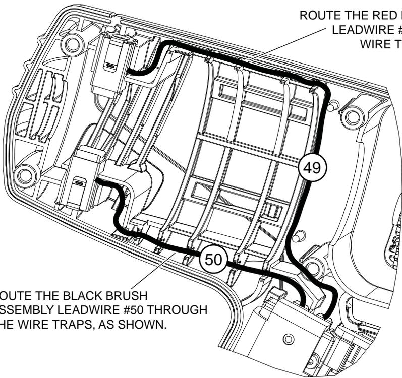
ROUTE THE BLACK BRUSH ASSEMBLY LEADWIRE #50 THROUGH THE WIRE TRAPS, AS SHOWN.
