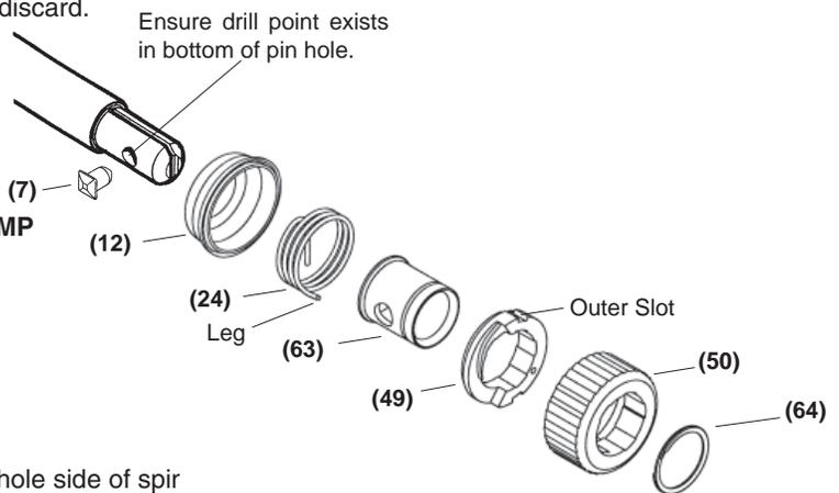
**REASSEMBLY OF THE STEEL QUIK-LOK® BLADE CLAMP**
