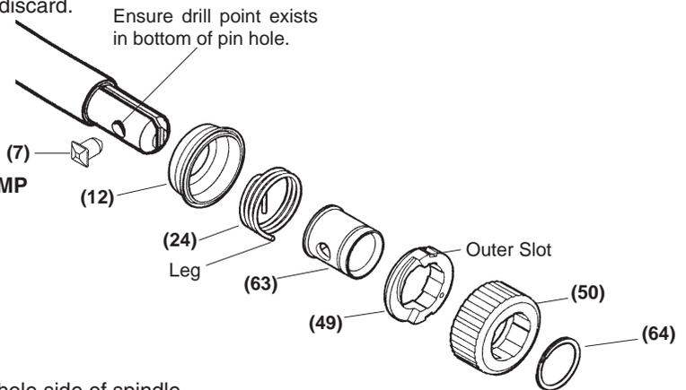
**REASSEMBLY OF THE STEEL QUIK-LOK® BLADE CLAMP**
