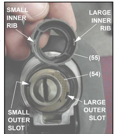
**REMOVING THE STEEL QUIK-LOK® BLADE CLAMP**
