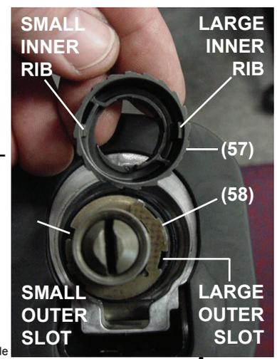
**REMOVING THE STEEL QUIK-LOK® BLADE CLAMP**
